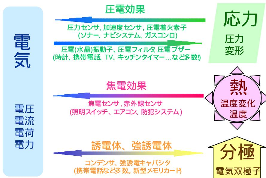
図.1.1 セラミクスなどの機能性材料の持つ機能の模式図
