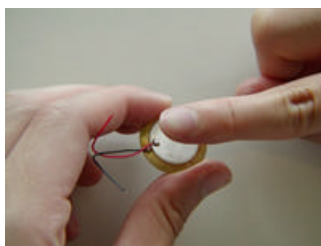
図 3.4 圧電センサを叩いてみる
