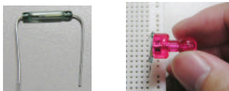
(a) 磁気センサ (b) 磁気センサに磁石を近づける
