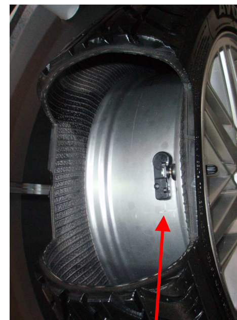
タイヤの中に空気圧センサ エネルギー源は振動?
